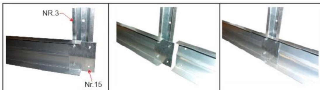
Obrázok 1.7 (spojenie predĺženia bokov základového rámu)
